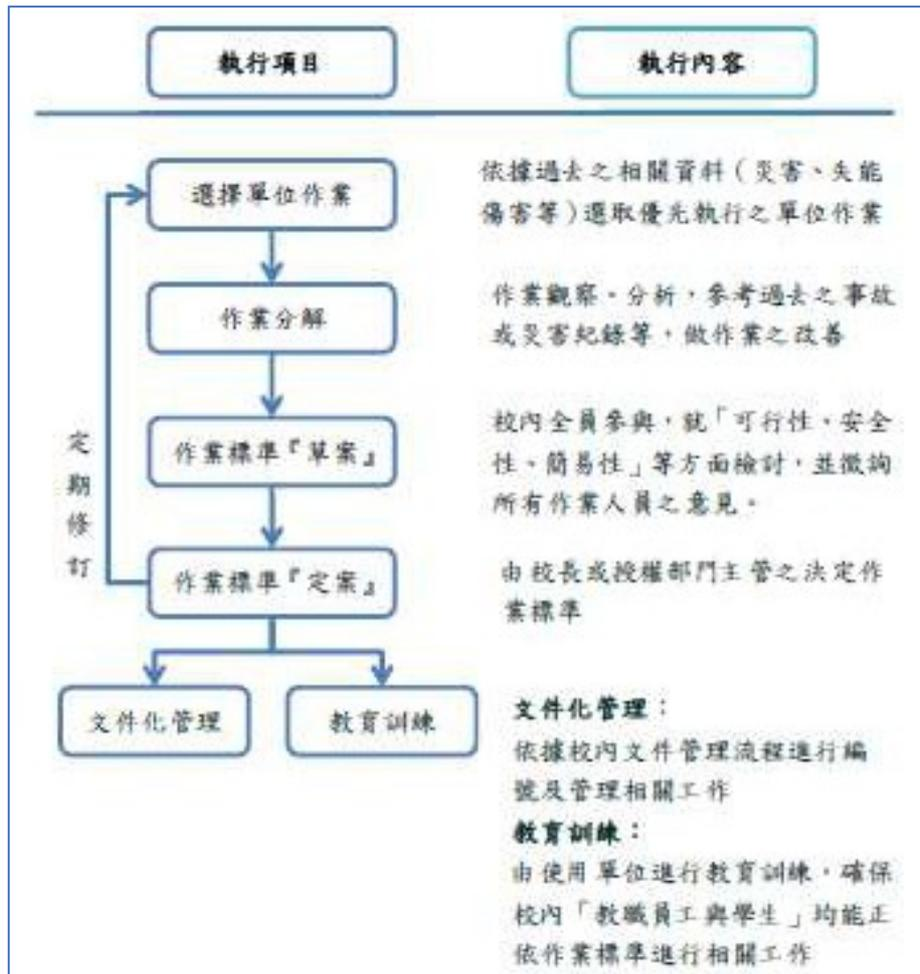
圖一 安全作業標準製作步驟
