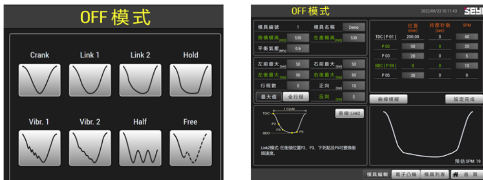
圖 3 基本伺服沖壓運動控制曲線
