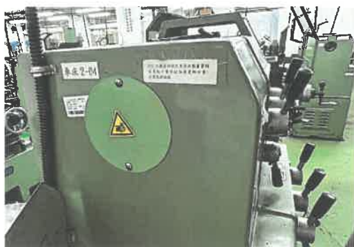
圖 3 _安裝車床主軸後端護板，防止捲入危險。
