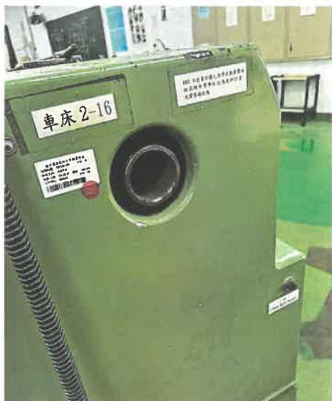
圖 1_原本車床無側邊主軸後端護板
